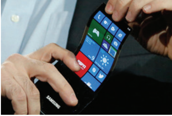
Resim 8.5 Bükülebilir OLED ekran.
