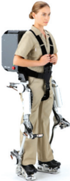
Resim 8.4 Güçlendirilmiş dış iskelet örneği.
